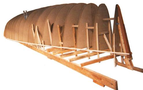
Si le traçage est très fiable (plotters échelle 1:1 ou découpe laser) les entailles sont faites avant le montage des formes, sinon il est préférable de monter les couples, vérifier et ajuster leur forme avec des longues règles souples, ensuite tracer sur place les encoches et les découper à la scie sauteuse.
