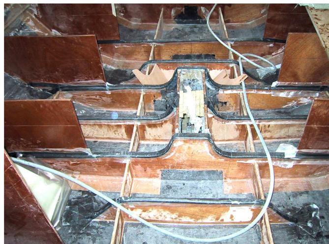
Schéma 6 : Joint-congé basse densité renforcé par un statifié Bi-axial (-45° / +45°)
